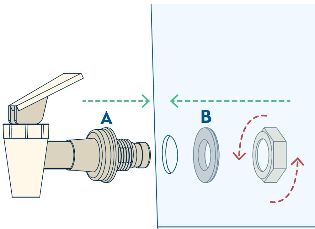
3. Instale el grifo y la junta A desde la parte externa del contenedor inferior en el orificio. Instale la junta B y ajuste la tuerca desde el interior del contenedor girándola en sentido de las agujas del reloj. Ajústelo bien.
