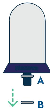
4. Retire la junta B adherida al filtro de cerámica y deje la junta A.
