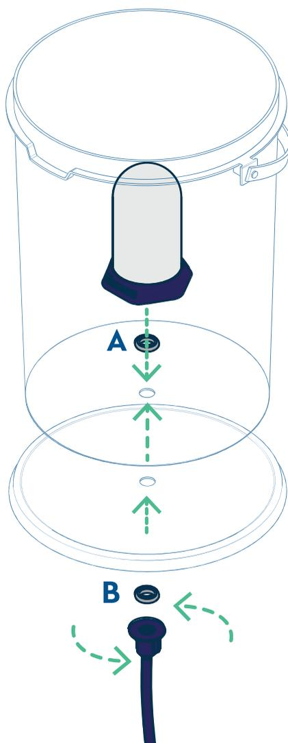
5. Instale el filtro de cerámica y la junta A en el orificio dentro del contenedor superior. Inserte la parte inferior del filtro de cerámica en el orificio de la tapa del contenedor inferior. Instale la junta B y ajuste el tubo al fondo del contenedor girando la tuerca en sentido de las agujas del reloj. Ajústelo bien.
