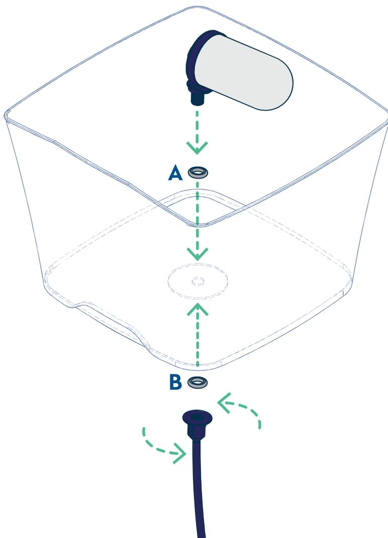
5. Instale el filtro de cerámica y la junta A en el orificio dentro del contenedor superior. Instale la junta B y ajuste el tubo al fondo del contenedor girando la tuerca en sentido de las agujas del reloj. Ajústelo bien.
