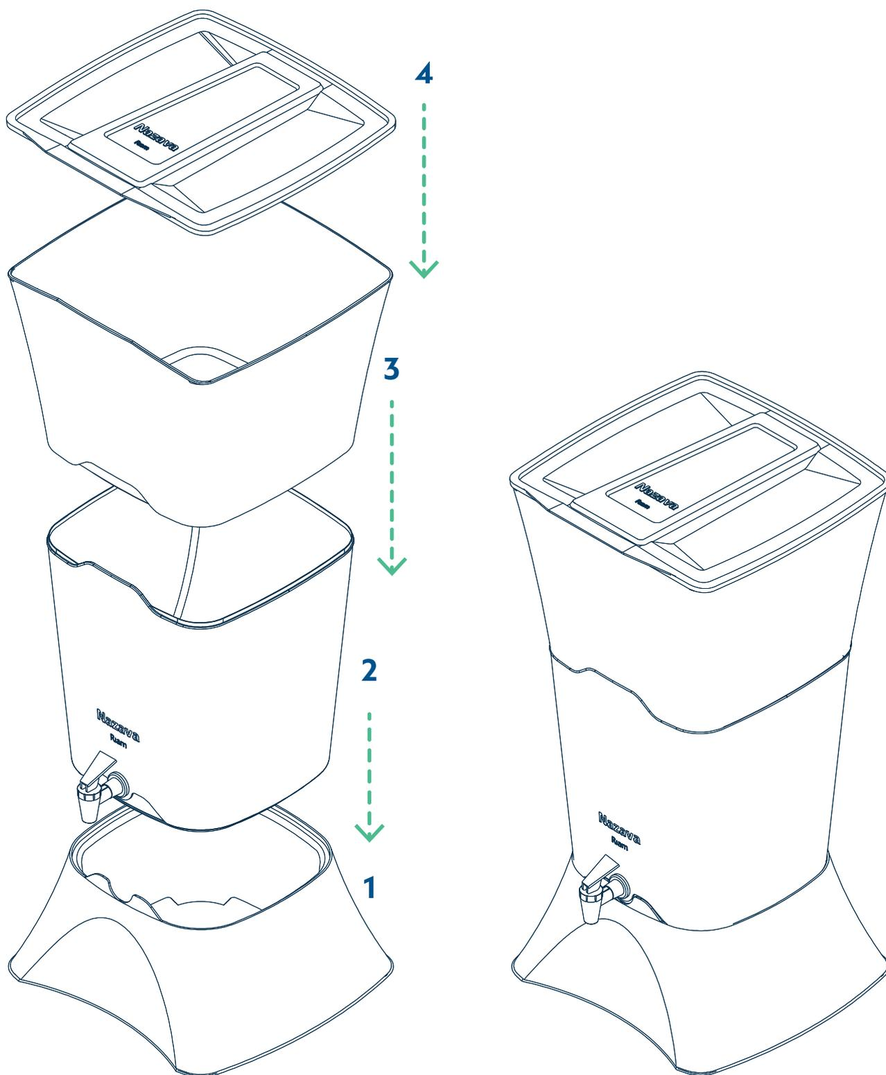
6. Coloque el contenedor inferior en la base, luego coloque el contenedor superior encima del contenedor inferior. Cubra el contenedor con la tapa.
