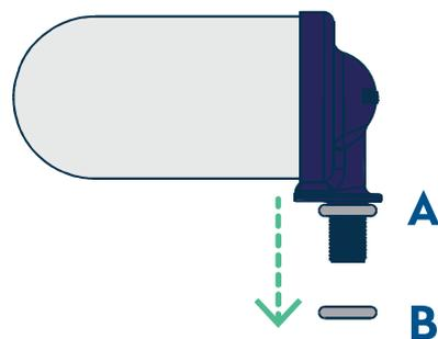
4. Retire la junta B adherida al filtro de cerámica y deje la junta A.
