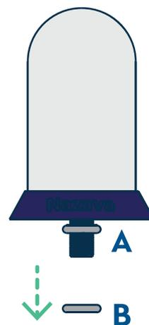
4. Retirez le joint B fixé au filtre en céramique. Laissez le joint A sur le filtre.
