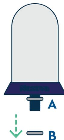
4. Retire la junta B adherida al filtro de cerámica y deje la junta A.
