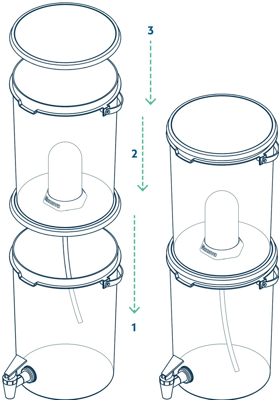
6. Coloque el contenedor superior con el filtro cerámica encima del contenedor inferior. Cubra el contenedor con la tapa.
