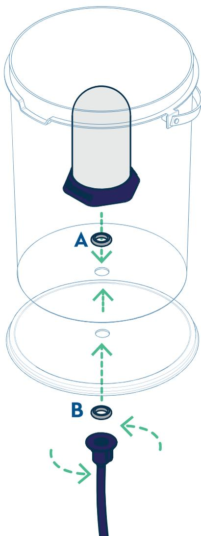
5. Instale el filtro de cerámica y la junta A en el orificio dentro del contenedor superior. Inserte la parte inferior del filtro de cerámica en el orificio de la tapa del contenedor inferior. Instale la junta B y ajuste el tubo al fondo del contenedor girando la tuerca en sentido de las agujas del reloj. Ajústelo bien.
