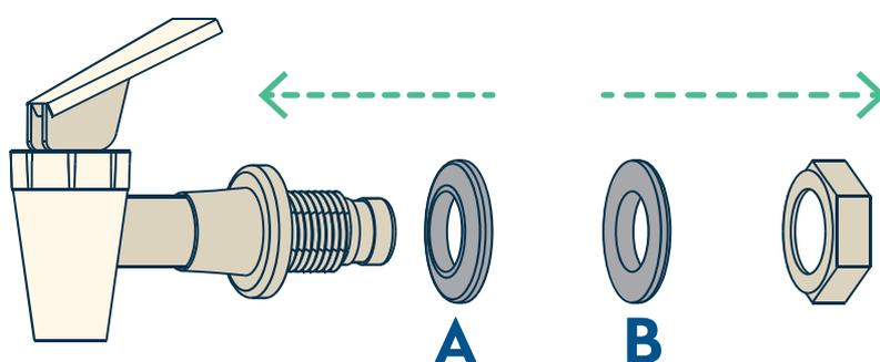
2. Retirer l'écrou et le joint B fixés sur le robinet. Laissez le joint A sur le robinet.
