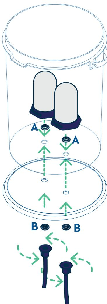
5. Installez le filtre céramique et le joint A dans le trou à l'intérieur du récipient supérieur. Insérez la partie inférieure du filtre en céramique dans le trou du couvercle inférieur. Installez le joint B et serrez le tuyau au fond du récipient en tournant l'écrou dans le sens des aiguilles d'une montre. Serrez fermement. Répétez le processus pour le deuxième filtre.
