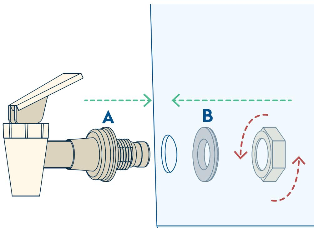
3. Installez le robinet et le joint A depuis l'extérieur du récipient inférieur dans le trou. Installez le joint B et serrez l'écrou depuis l'intérieur du récipient en tournant l'écrou dans le sens des aiguilles d'une montre. Serrez fermement.
