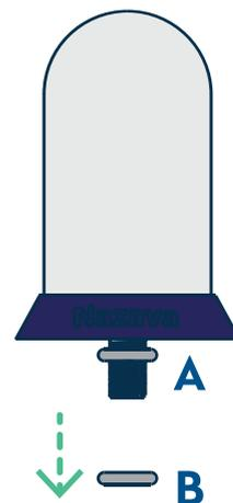
4. Retirez le joint B fixé au filtre en céramique. Laissez le joint A sur le filtre.
