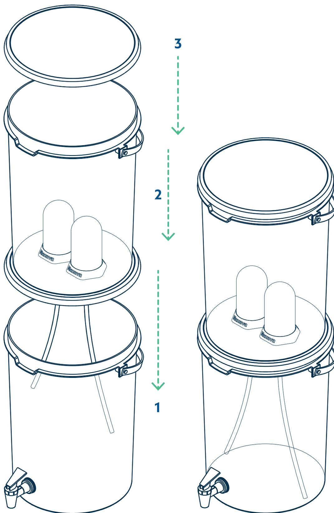
6. Placez le conteneur inférieur avec le filtre céramique sur le support, placez le conteneur supérieur sur le conteneur inférieur. Couvrez le conteneur avec le couvercle.
