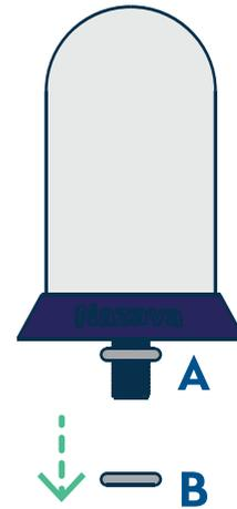
4. Retire la junta B adherida al filtro
