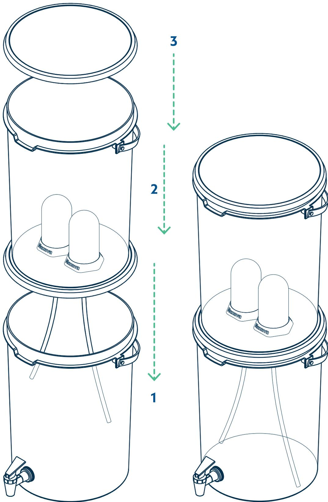
6. Coloque el contenedor superior con el filtro cerámica encima del contenedor inferior. Cubra el contenedor con la tapa.
