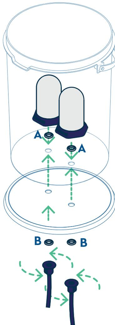
5. Instale el filtro de cerámica y la junta A en el orificio dentro del contenedor superior.
