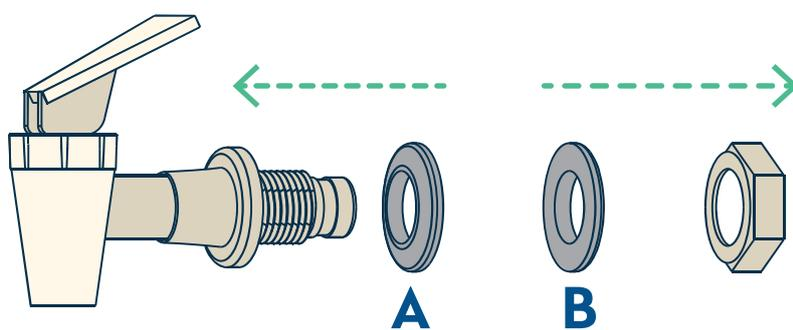
2. Retire la tuerca y la junta B adheridas al grifo. Deje la junta A en el grifo.
